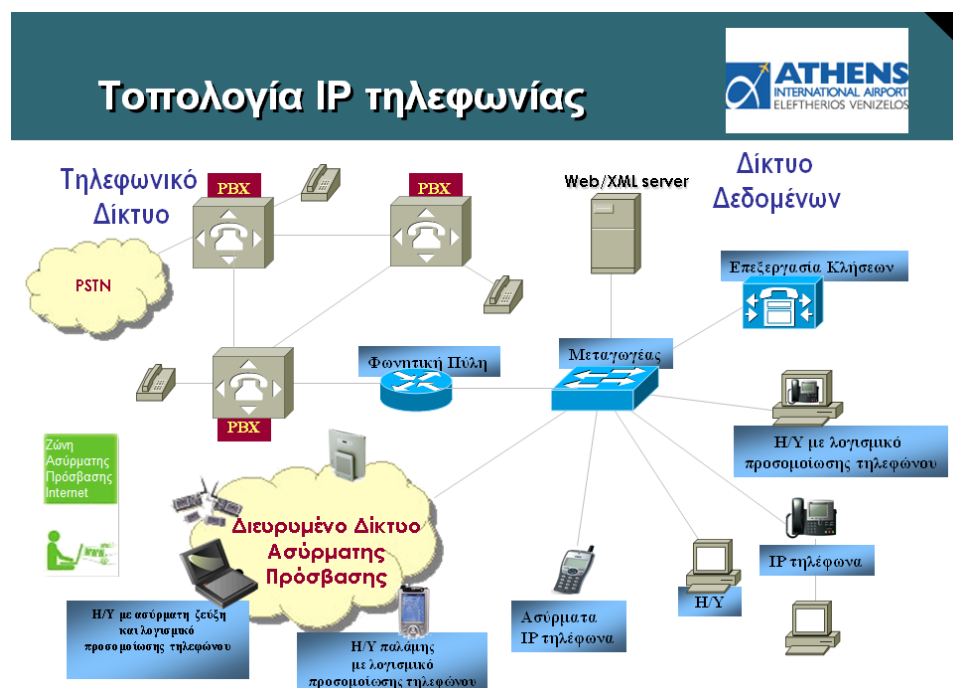
Σχήμα 6: Τοπολογία IP τηλεφωνίας στο Διεθνή Αερολιμένα Αθηνών
