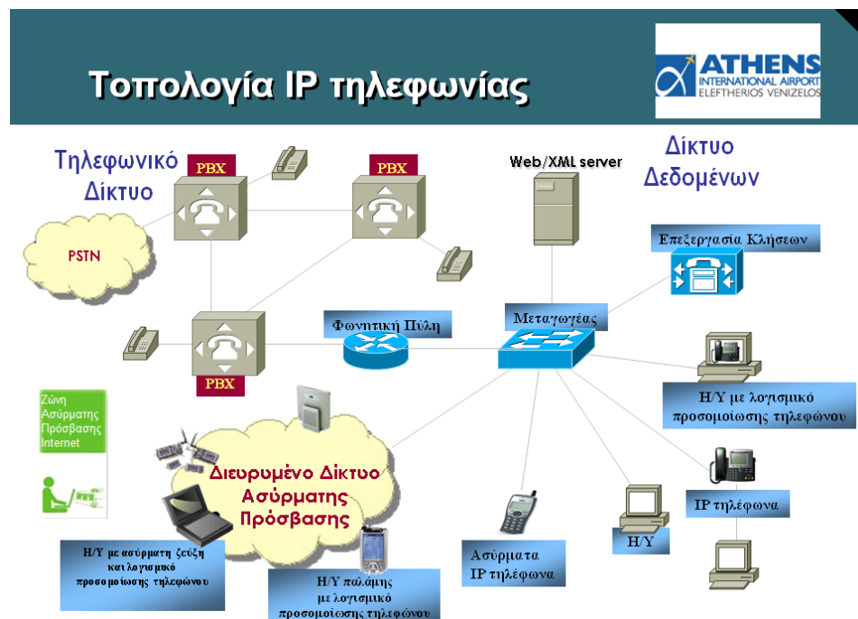
Σχήμα 6: Τοπολογία IP τηλεφωνίας στο Διεθνή Αερολιμένα Αθηνών
